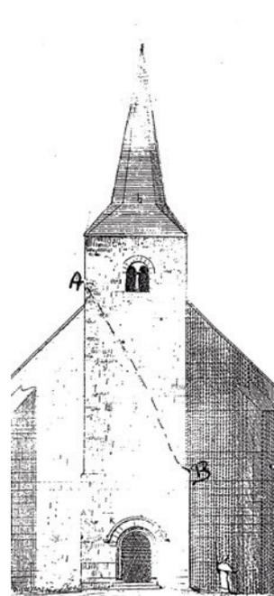
Photo 3 : Travaux de reconstruction du clocher en 1919. La ligne A - B marque le point de reprise de la construction.
